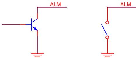
图 4.6 驱动单元提供信号的两种方式
