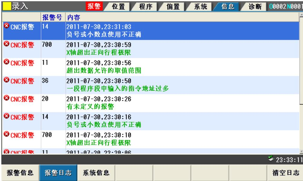
报警日志画面显示最近发生的报警，最多可以显示100条报警记录，报警记录的按时间的先后排列。按
