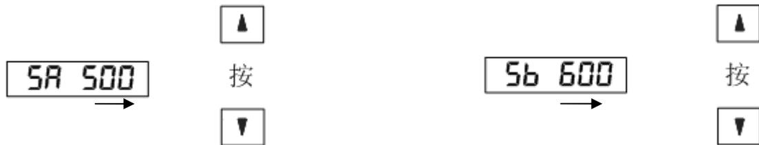
图 6.13 速度试运行操作框图
