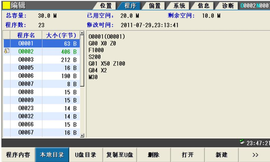
本地目录列出了CNC内部保存的所有零件程序,并显示存储空间的使用状态。上下移动光标可预览程序,预览的内容在右边画面显示,被预览的程序的修改时间显示在列表上方。
