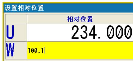
(5) 按编辑键盘上的
