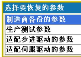
C级权限时第一项为“用户备份的参数”，源数据为C级权限下备份的参数；B级权限时第一项为“制造商备份的参数”，源数据为B级权限下备份的参数。另外三项参数是为了方便在各种条件下调试而内置的几套参数。
