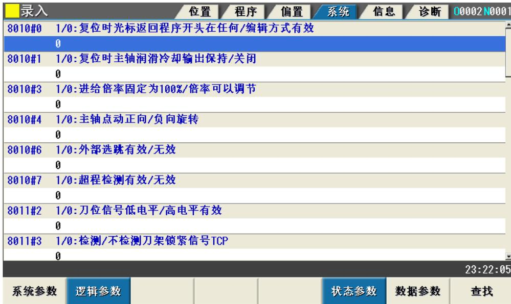
逻辑参数按功能分为两类：状态参数和数据参数。通过软功能键 状态参数 和 数据参数 切换到对应的子画面。
