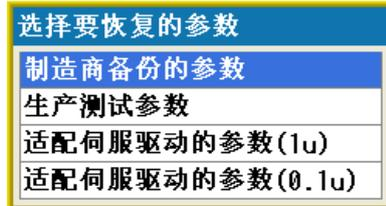
C级权限时第一项为“用户备份的参数”，源数据为C级权限下备份的参数；B级权限时第一项为“制造商备份的参数”，源数据为B级权限下备份的参数。另外三项参数是为了方便在各种条件下调试而内置的几套参数。
