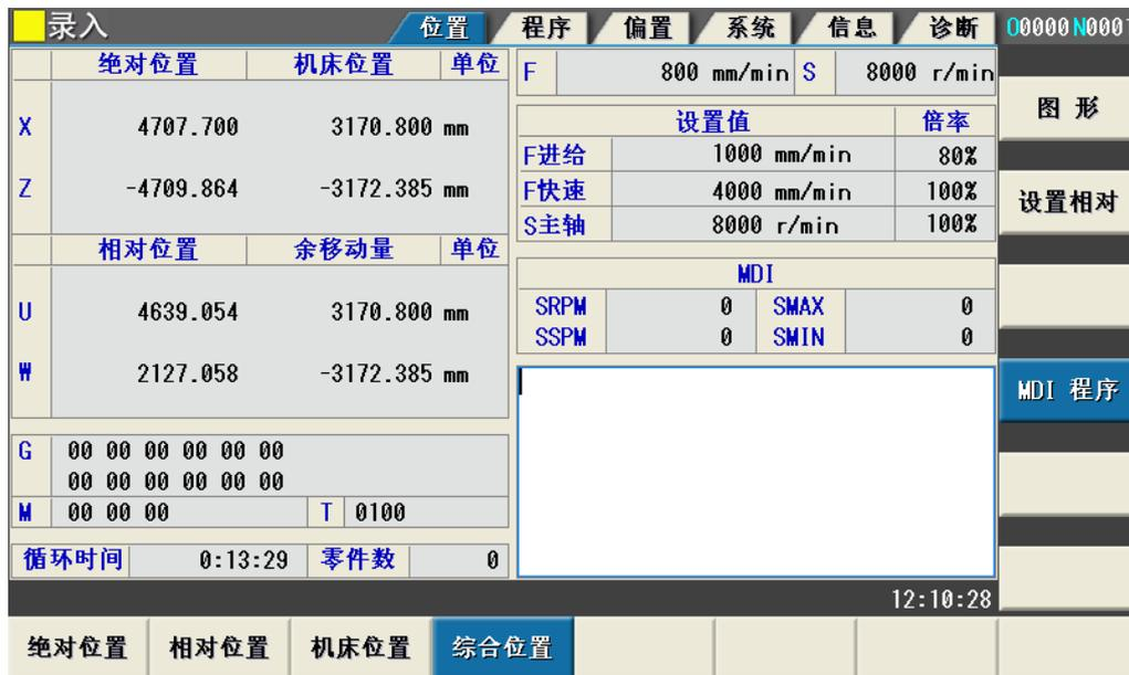
在输入框中输入MDI程序，输入完成后按【循环启动】按钮，执行已编辑的程序。
